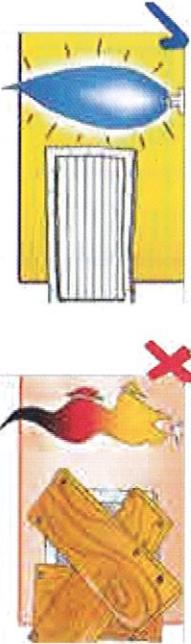
Quel que soit le combustible (*gaz, fuel, bois, charbon, etc.*), pour qu'une flamme brûle sans produire de gaz dangereux (*monoxide de carbone*), il faut impérativement de l'air. Une grille d'aération est indispensable pour laisser entrer l'air neuf. Si l'appareil est prévu pour fonctionner sans conduit d'évacuation, une grille d'aération haute est nécessaire pour assurer l'évacuation des gaz brûlés.
